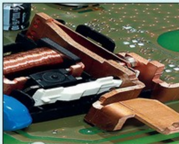
Le disjoncteur intégré au compteur Linky
